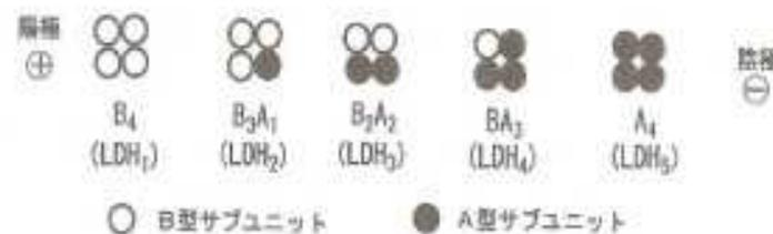
図1. LDHのアイソザイム構造とその電気泳動パターン
